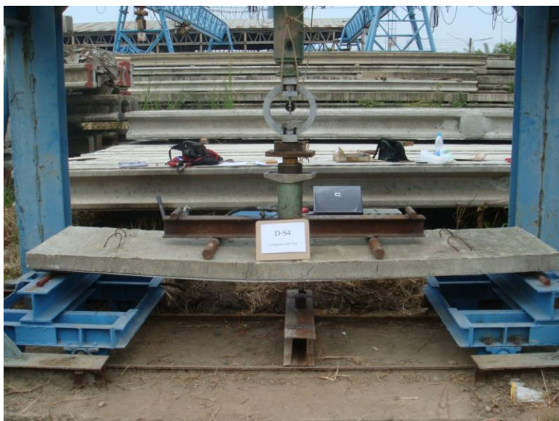
ภาพที่ 3.2 การวิบัติของตัวอย่างการในการทดสอบรับแรงดัดแบบสี่จุด (Four-Points Bending Test)
