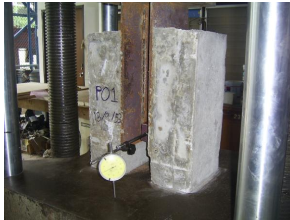
ภาพที่ 2.8 การติดตั้งตัวอย่างและอุปกรณ์การทดสอบ Push-Out
