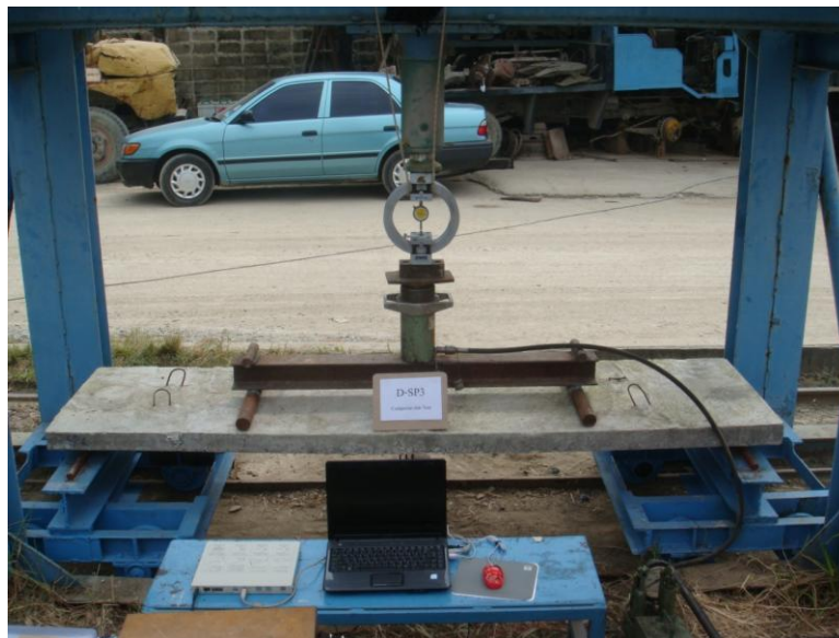
ภาพที่ 2.9 การติดตั้งตัวอย่างและอุปกรณ์การทดสอบรับแรงดัดแบบสี่จุด (Four-Points Bending Test)
